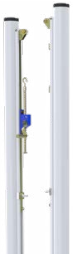
S30161 - Trụ chôn nòng, thép ống Ø90mm, căng lưới bằng tăng đơ, dùng cho tennis bãi biển.
