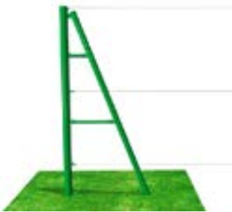
Trụ trung gian 1 trụ gia cố.
